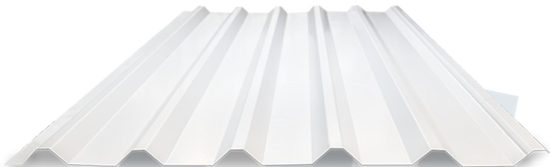
Perfil acanalado de configuración trapezoidal fabricado en planta mediante una roladora estacionaria a partir de un rollo de acero de ancho 0.91 m, diseñado para ser utilizada como cubierta de fijación expuesta.
