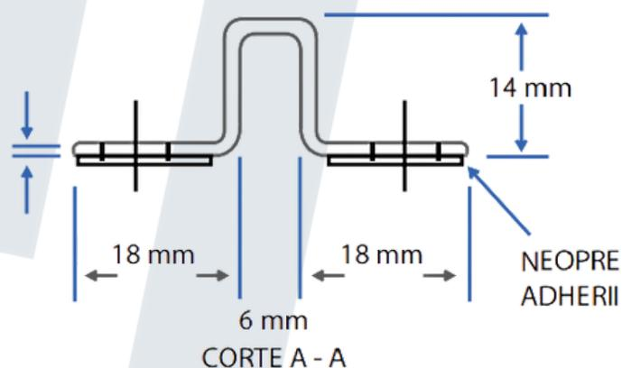
Las placas de fijación para Multytecho son utilizadas para fijar dos piezas de Multytecho por los costados, ya que se incorpora en los canales del machimbre y se pija en los cuatro orificios de la placa.
