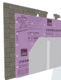
Instalación en muro interior con tablero de yeso.
