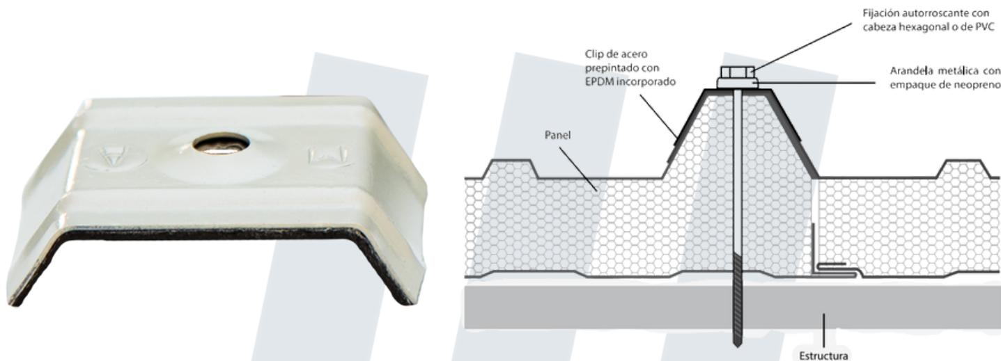
El Clip de Sujeción para Galvatecho, tiene la función de fijación del Galvatecho a la estructura de la construcción donde se pretende instalar
